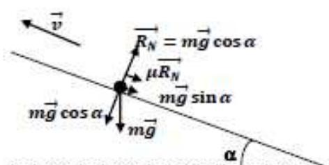
Riferendoci allo schema a lato è evidente che la forza di trascinamento, per avere una velocità di risalita costante, dovrà essere pari a:
