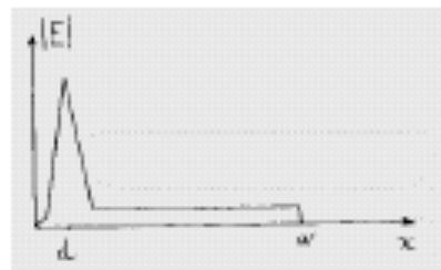
La moltiplicazione avviene all'inizio e poi tutti gli e secondari vanno verso la fine del diodo
