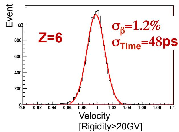
Il TOF misura la velocità delle particelle, dalla misura del "tempo di volo"  $T$  fra gli scintillatori sup e inf.
