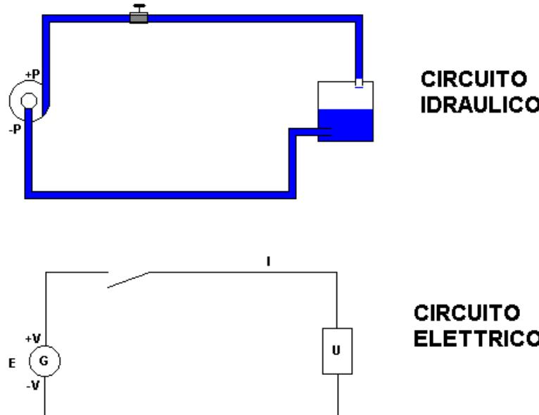
Nel circuito idrico il liquido scorre spontaneamente verso il basso, ma per poter tornare nel recipiente c'è bisogno di una pompa che mantenga costante la differenza di livello tra il liquido nel recipiente e il tubo.
