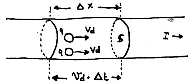
UN FILO DI RAME CON SEZIONE DI AREA  $3.0 \cdot 10^{-6} \text{ m}^2$  E' PERCORSO DA UNA CORRENTE DI 10.0 A. TROVARE LA VELOCITA' DI DERIVA DEGLI ELETTRONI IN QUESTO FILO. LA DENSITA' DEL RAME E'  $8.95 \text{ g/cm}^3$ .
