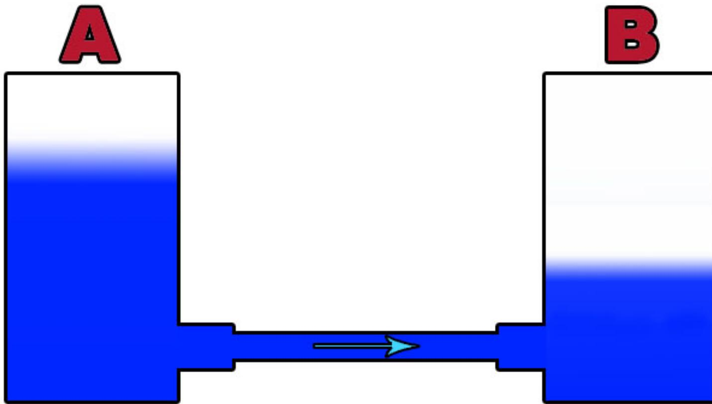
Così come nel circuito idrico è necessaria una pompa per mantenere il dislivello tra i due recipienti, nel circuito elettrico per mantenere la **differenza di potenziale elettrico** c'è bisogno di un **generatore** (es. pila).
