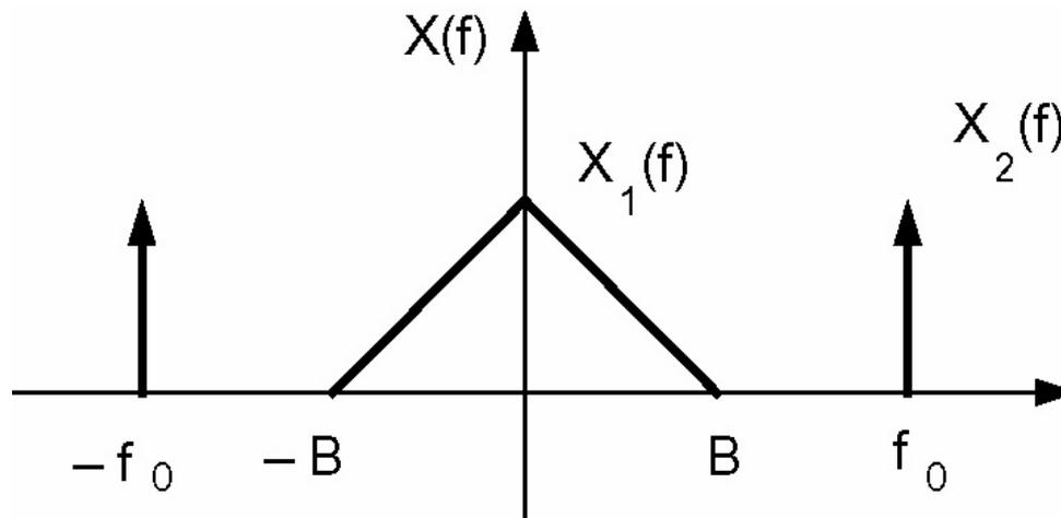
abbiamo bisogno di un apparato con caratteristiche di selettività delle differenti componenti frequenziali del segnale: un filtro
