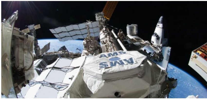
Figura 3.1: L'esperimento Alpha Magnetic Spectrometer (AMS-02) sulla Stazione Spaziale Internazionale
